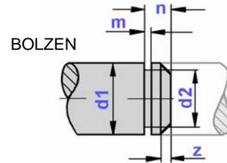
**KL-SICHERUNGEN FÜR BOLZEN UND WELLE**
